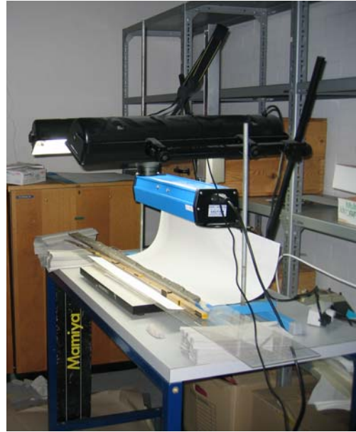
Figur 1.1: Fotoopstilling ved billeder taget oppefra. Den blå lampe i midten er en Cole Parmer 30 W 312 nm UV-lampe, mens de to sorte lamper i siderne er Kaiser RP-5000 fotolamper med 2 x 18 W lysstofrør. Kamera er fastspændt i midten på fotostanden.
