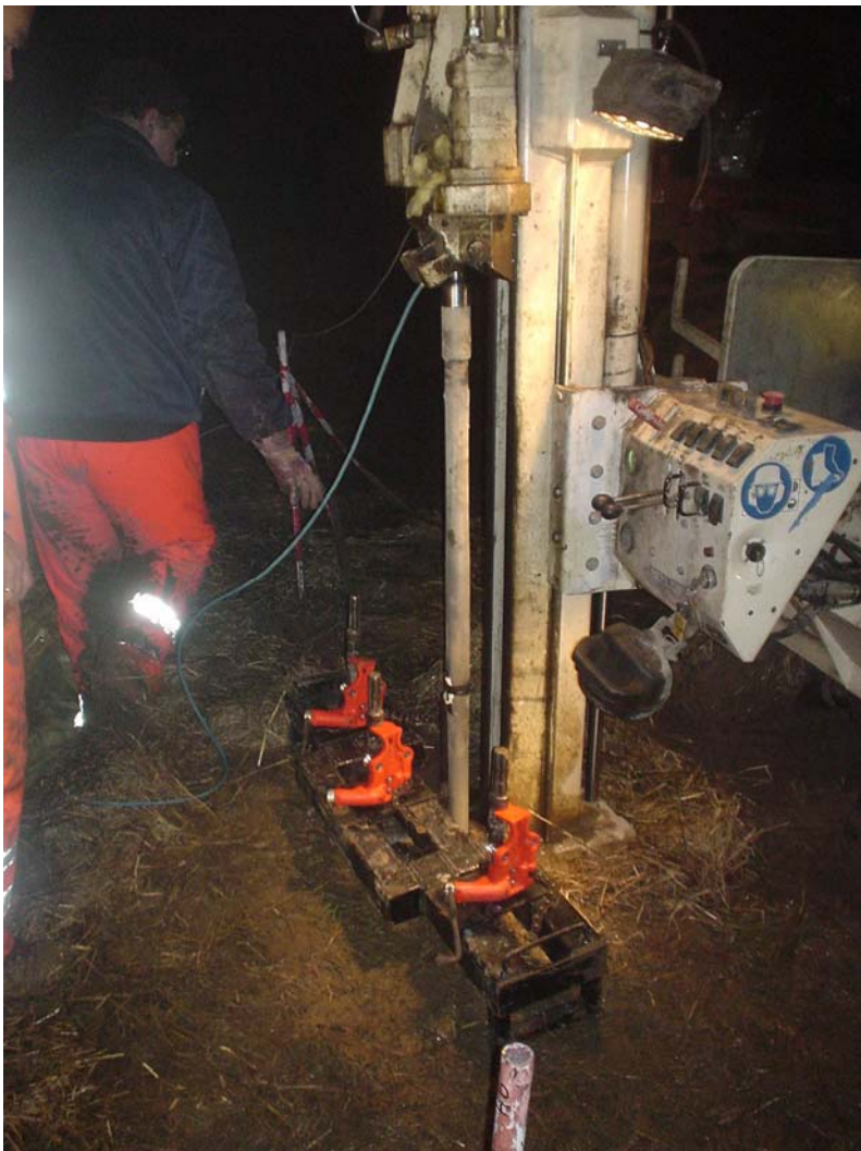
FFD-sonde med målevinduet afdækket inden nedpresningen med NIRAS' GeoProbe system.
