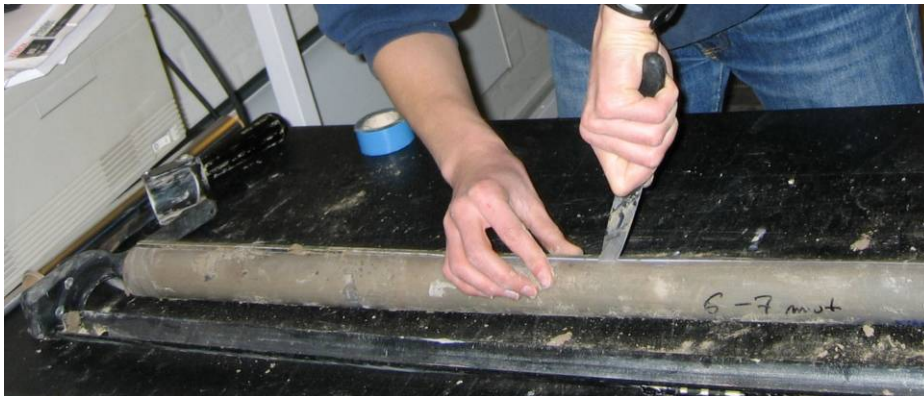
Figur K2.3: Opskæring af kerne.
