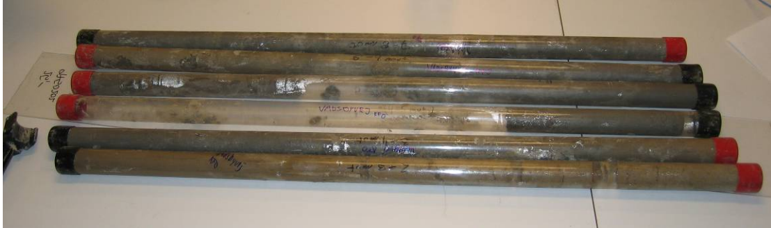
Figur K2.1: KF0-kerner fra Glostrup inden opskæring.
