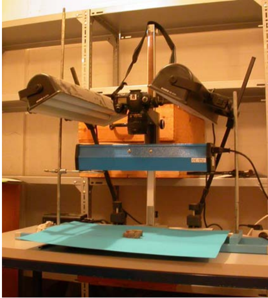
Figur 1.1: Fotoopstilling ved billeder taget oppefra. Den blå lampe i midten er en Cole Parmer 30 W 312 nm UV-lampe, mens de to sorte lamper i siderne er Kaiser RP-5000 fotolamper med 2 x 18 W lysstofrør. Kamera er fastspændt i midten på fotostanden.
