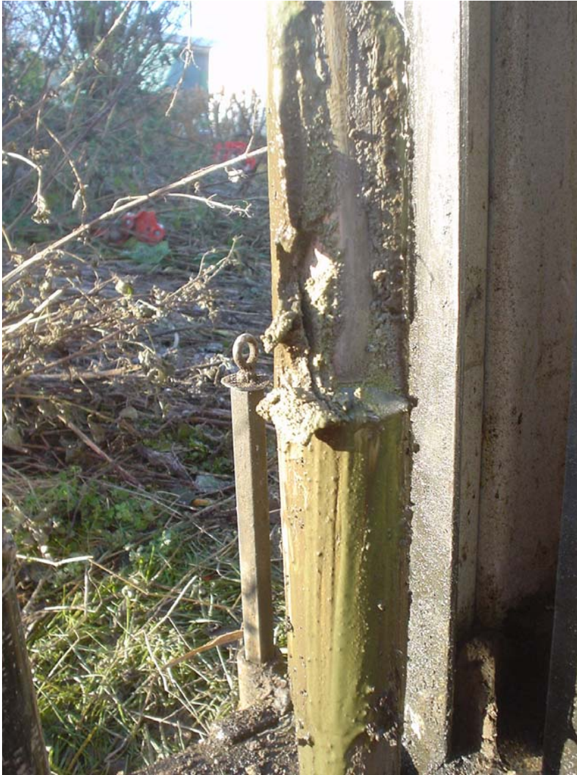
FFD-sonde dækket af blød silt og med tydelig grøn farve på ydersiden
