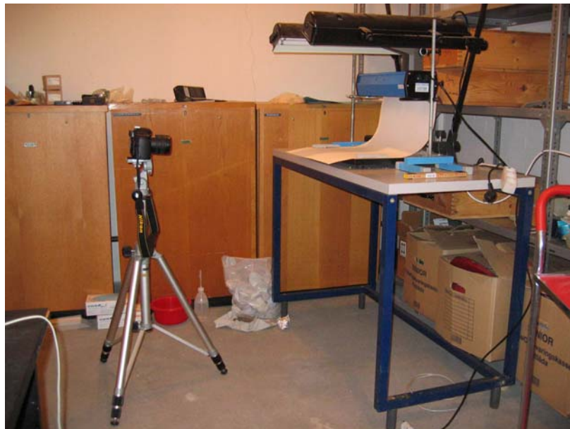
Figur 1.2: Fotoopstilling ved billeder taget forfra. Den blå lampe i midten er en Cole Parmer 30 W 312 nm UV-lampe, mens de to sorte lamper i siderne er Kaiser RP-5000 fotolamper med 2 x 18 W lysstofrør. Kamera står på trefod (fotostadie).
