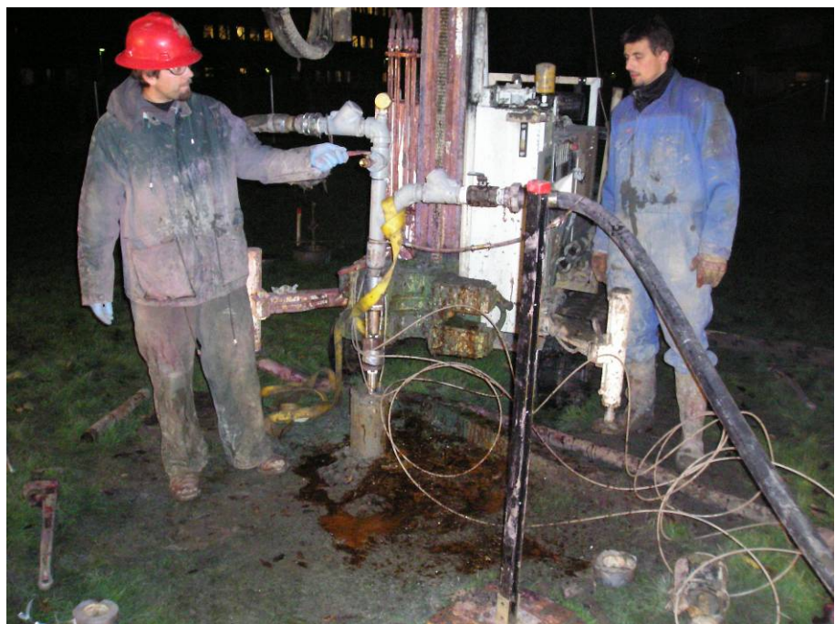
Figur 6.7 Opskydning af gas og substrat i og ved PF1 som følge af gaspuls efter substratinjektion 3-4 m.u.t.
