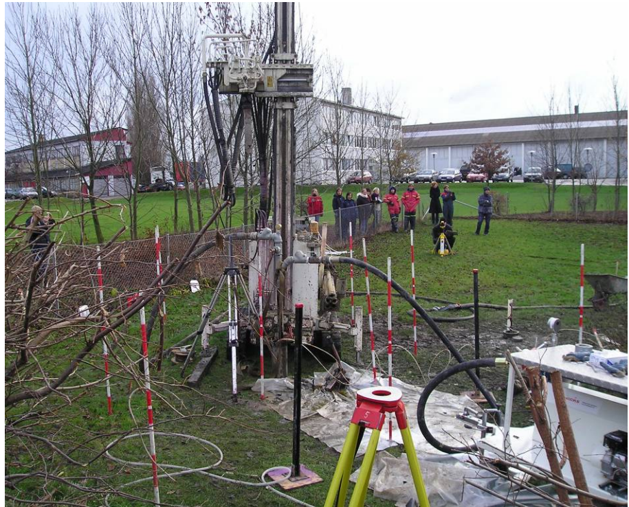
Figur 5.5 Testfelt 2 under pneumatisk frakturering
