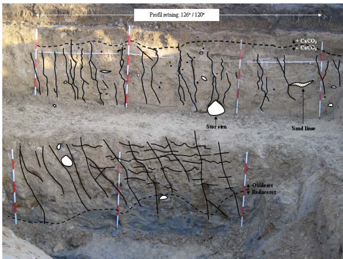
Figur 2 Foto af primære udgravningsprofiler på Vadsbyvej. Overordnede sprækker, kalk- og redoxgrænse, sandlinser og store sten er fremhævet. Inddelinger på landmålerstokke er 20 cm. Optegnet fra /2/.
