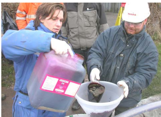
Figuren viser injektion af farvestoffer på en forurenet lokalitet ved Glostrup for at dokumentere dannelsen af sprækker ved pneumatisk frakturering.
