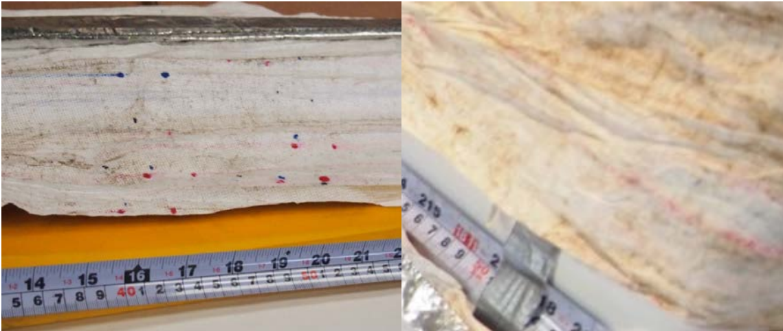
Figur 28: Eksempler på farvemarkeringer på NAPL membran fra CTF1. Til venstre ses tydelige prikker (0,40-0,56 m u.t.), mens der til højre ses næsten utydelig rødlig farvemarkering (5,6 m u.t.).
