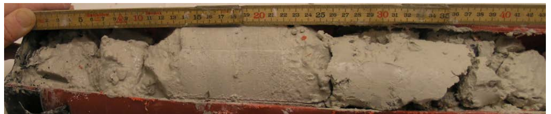
Figur 38: Foto af kerne C1-4 udtaget 12,04-13,39 m u.t. fra boring C1. Prøve med residual DNAPL er taget ca. 8 cm fra bunden (venstre side) i det bløde område.
