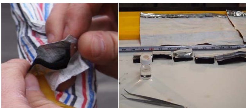
Figur 4: Aktiv kulstof filt påsyet bagsiden af den hydrofobe membran og beskyttet af diffusionsbarriere i aluminium (venstre) og prøvetagning af aktiv kulstof filt (højre)
