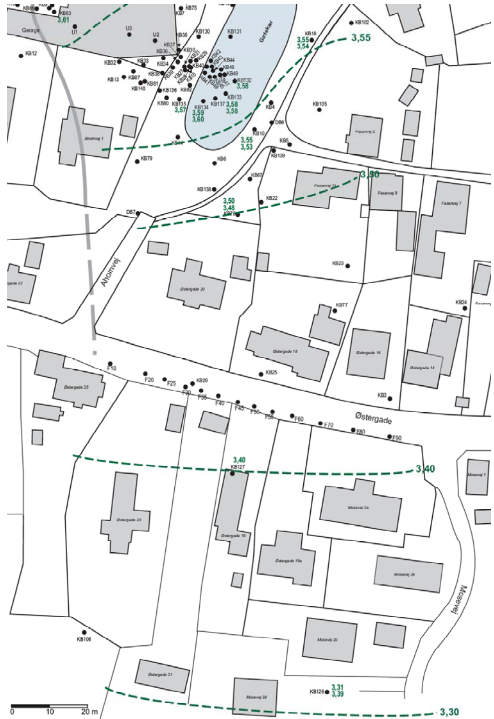
Figur 2.6: Potentialekort (m DVR90) for øvre sekundært magasin for oktober 2008, modificeret fra Region Hovedstaden (2010). Bemærk at skala i venstre hjørne nok ikke er helt præcis, idet den er klippet ind separat.
